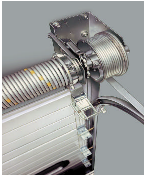
Bild 18: Federbruchfangvorrichtung auf der Welle eines Sektionaltores
